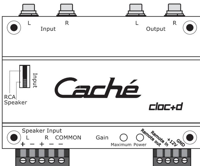
**LINE DRIVER / LINE OUTPUT CONVERTER**
