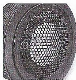
トゥイーターは、振動板素材違いでa:アルミとs:シルクの2モデルが用意される。マグネットはネオジウムで、磁性流体タイプの冷却システムを持つ。
