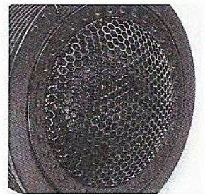
トゥイーターは、振動板素材違いでa:アルミとs:シルクの2モデルが用意される。マグネットはネオジウムで、磁性流体タイプの冷却システムを持つ。
